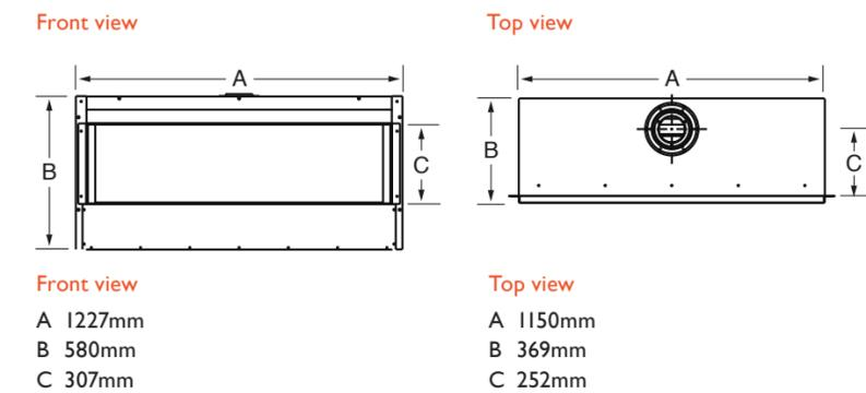
EDEN ELITE SLIMLINE BALANCED FLUE
